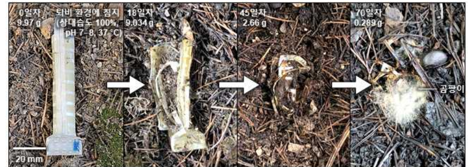
(그림2) 소프트 로봇 손가락의 생분해 과정
